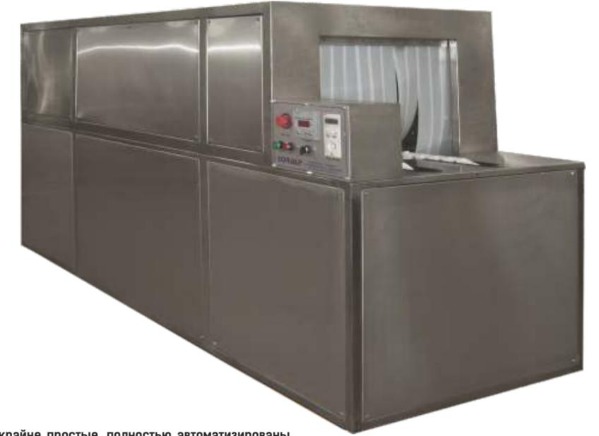
Использование наших машин, их чистка и уход за ними крайне простые, полностью автоматизированы. Машины оснащены металлическим фильтром для сбора отходов, что положительно влияет на окружающую среду. Во время мытья используются разбрызгиватели, обеспечивающие 100% однородное и качественное мытье всей посуды. Насос и вентиляторы, установленные в моечной машине, предназначены для промышленного использования и отличаются крайней долговечностью.
